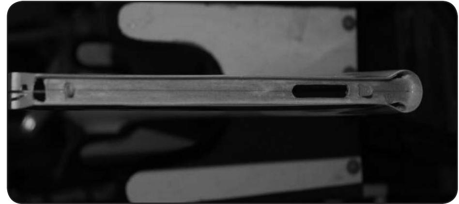
**24** Anlenkgestänge durch den Rumpf nach vorne führen und mit dem Ruderhorn der Seitenruderklappe verbinden.
