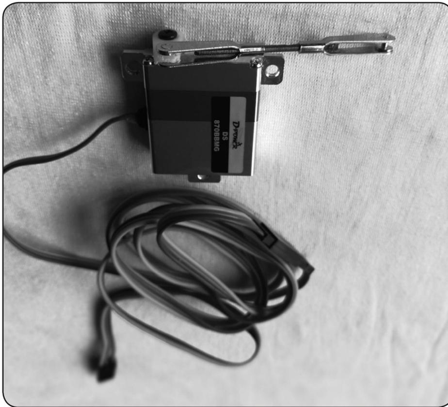
**02** Servoschacht mit Schleifpapier anrauen und danach Schleifstaub entfernen. Servokabel durch die Tragflächenhälfte ziehen. Servo mit Tesa Powerstripes in Servoschacht kleben.
