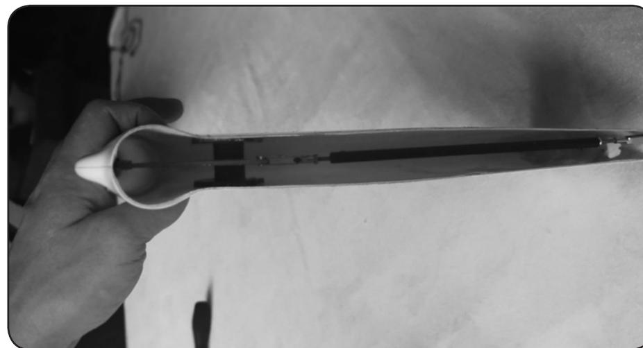
**21** Ein Loch für das Ruderhorn in die Seitenruderklappe bohren. **HINWEIS: Das Loch für das Ruderhorn muss in einer Flucht mit dem Anlenkgestänge liegen.** Das Ruderhorn in die Seitenruderklappe mit Epoxidharz einkleben.
