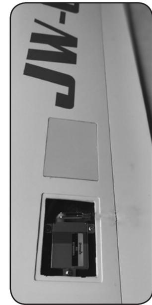
**12** Servoschachtabdeckung mit Tesa befestigen.
