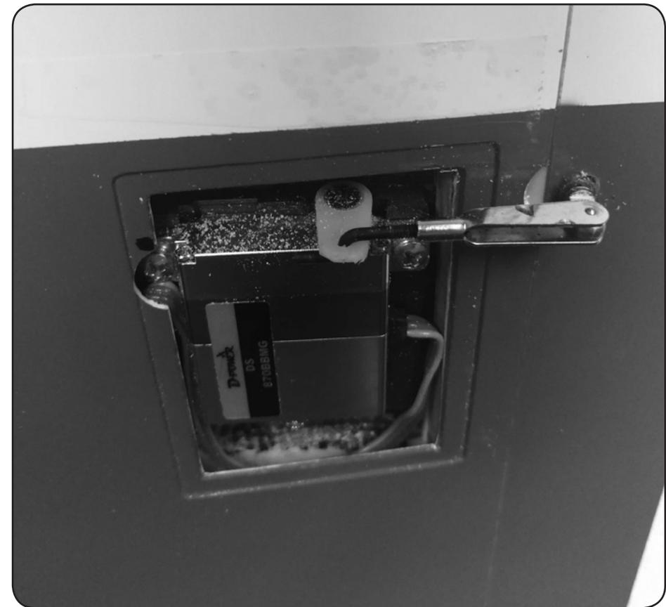
**04** Servoschachtabdeckung mit Tesa befestigen.
