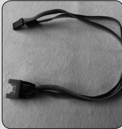
**29** Kabel durch den Rumpf ziehen und die MPX Buchsen bündig in die beiden (L + R) passenden Ausschnitte der Flächenanformungen mit Epoxidharz kleben.
