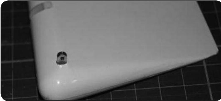
**22** Die GFK-Verbinder in die Aussparungen der Seitenruderklappe stecken und von oben eine Carbonstange einführen um die Verbinder gegen verrutschen zu sichern. Carbonstange oben an der Seitenruderklappe mit Tesafilm sichern.
