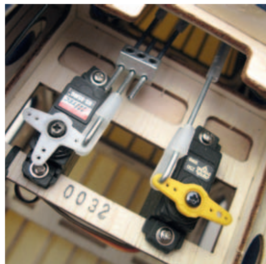
Die Höhenruderhälften werden einzeln angelenkt
