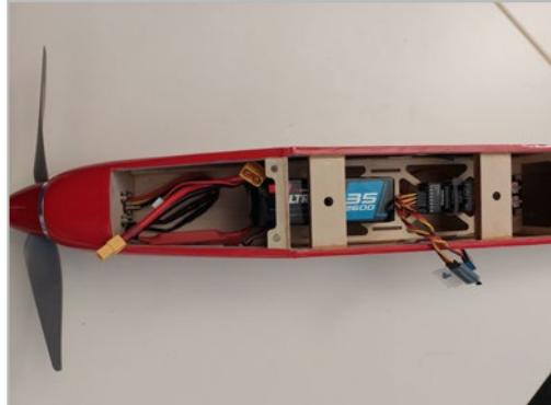
Bei Verwendung des empfohlenen Akkus, sitzt dieser im Bereich unter der vorderen Flächenverschraubung. Dies ist geg. mit dem erforderlichen Schwerpunkt zuvor zu überprüfen.
