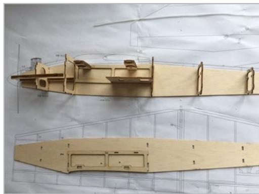
Befestigen Sie die Rumpfspanten (B1 für Verbrennerversion B3/6/7/8/9) und den Motorträger (B2) an einer Seite der Rumpfseitenwand entsprechend der Position auf dem Plan.
