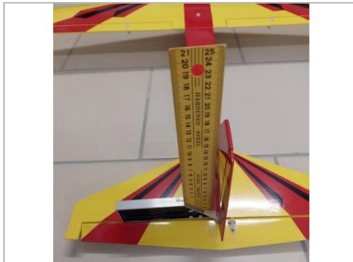
Verschleifen Sie nun alle Leitwerksteile und runden Sie Randbögen sowie Nasenleisten ab. Anschließend kann das komplette Leitwerk probeweise in den Rumpf geschoben werden um korrekten Sitz/Symmetrie prüfen zu können.
