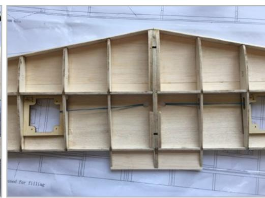
Nun muss das Loch zur Durchführung der Servokabel gebohrt werden. Je nach verwendetem Kabelquerschnitt reicht eine Bohrung von ca. 4-5mm aus. Gleichzeitig empfehlen ein Stück Schnur durchzuführen wie in Abbildung ersichtlich, um später das Servokabel einfacher durch die Tragfläche fädeln zu können.
