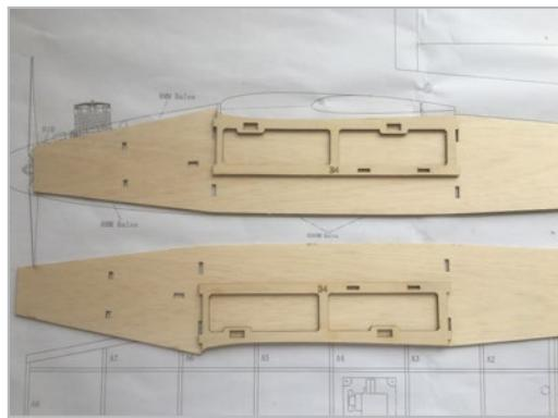
Kleben Sie die Sperrholzseitenteile (B4) auf die Seitenwände des Rumpfes, und beachten Sie, dass die beiden Seiten symmetrisch sein müssen.
