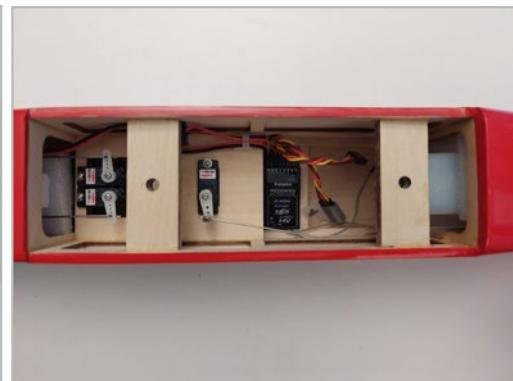
Der Empfänger sitzt hinter dem Akku und vor den Servos gemäß Abbildung bei der Elektroversion bzw. hinter dem Tank bei der Verbrennerversion.
