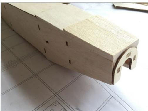
Die untere Rumpfabdeckung aus 8mm Balsa (B17) verschließt den Rumpfboden.
