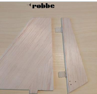
Die Scharniere werden wie in der nachfolgenden Abbildung eingesetzt. Auf der Ruderflanschseite muss zuvor eine gleichseitige Abschrägung geschliffen werden, um später den erforderlichen Ruderausschlag zu ermöglichen.
