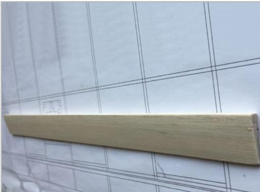
Anschließend werden die beiden Querruder sauber in Form geschliffen. Die vordere Kante der Ruder muss beidseitig abgeschrägt werden, um später den erforderlichen Ruderausschlag zu ermöglichen.
