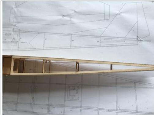
Kleben Sie nun die Balsaleisten 6x6mm (B19) auf die Rumpfseitenwand oben und unten sowie die kurzen Bodenverstärkungen 6x6mm (B15) gemäß Bauplan/Abbildung.
