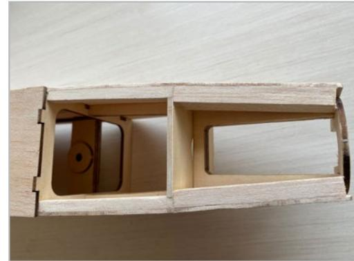
Der untere Teil des Rumpfes wird mit Balsaerstärkung 5mm (B20) im vorderen Motorraum verstärkt.
