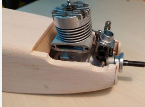
Den Motor sorgfältig am Motorträger verschrauben. Die Mitnehmerscheibe sollte etwas über dem Rumpfkopf überstehen, damit der Spinner später nicht streift. Für sämtliche Anbauteile des Motors geg. Aussparungen am Rumpf erstellen. Achten Sie auf ausreichend Abstand zu den Holzteilen im besonderen für die Drosselkükenanlenkung.
