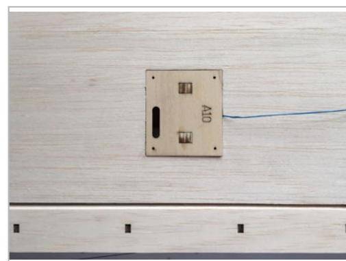
Die Servohalterung wird aus den Teilen (A10+A11) wie in der Abbildung ersichtlich zusammengeklebt. Wird ein Servo abweichend vom empfohlenen Zubehör verwendet, muss geg. die Halterung angepasst werden. Die Servohalterung sollte anschließend ohne Spalt und gleichmäßig am Rahmen in der Tragfläche aufliegen. Auch hier geg. Aussparung im Flügel zuvor nacharbeiten.
