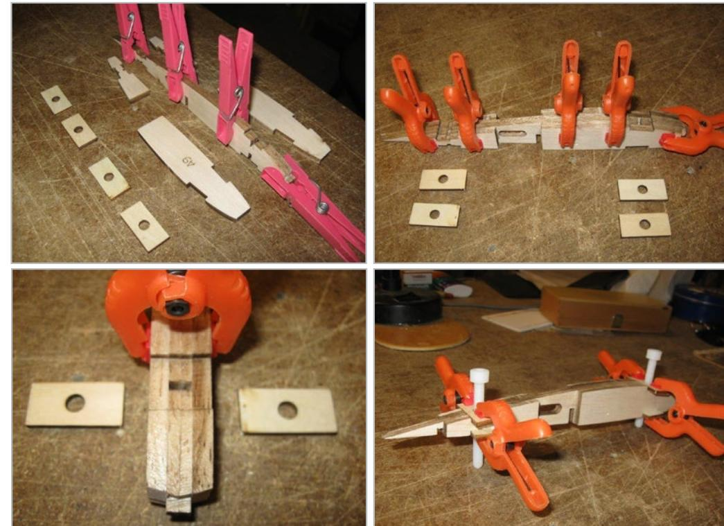
Verkleben Sie zwei Balsabretter mit der Beschriftung „Down“ für die Tragflächenbeplankung nebeneinander. Anschließend kann diese untere Beplankung auf die Bauhelling gelegt werden. Die Verzapfungen der Bauhelling sollten sauber mit den Ausnehmungen der Balsabeplankung übereinstimmen.
