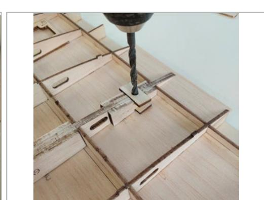
Anschließend müssen die beiden Bohrungen ( $\varnothing$  6mm) für die Tragflächenverschraubung durch die untere Beplankung gebohrt werden.
