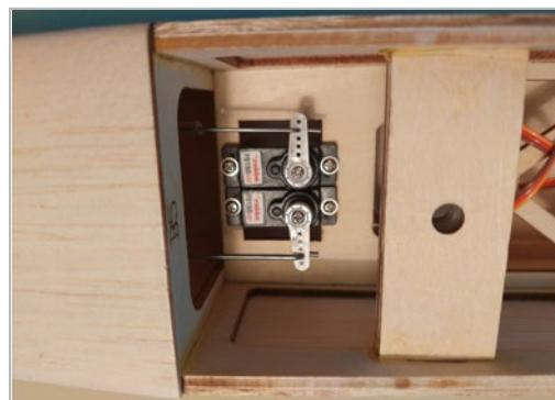
Die beiden Servos in den dafür vorgesehen Ausschnitt mittig einschrauben und das 1,2mm Anlenkgestänge wie in Abbildung ersichtlich bei zuvor auf „neutral“ gestellten Servos fertig montieren.
