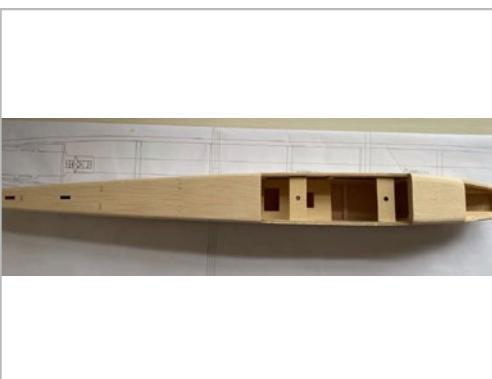
Abschließend muss der komplette Rumpf verschliffen und an den Kanten der Rumpfseitenwände abgerundet werden
