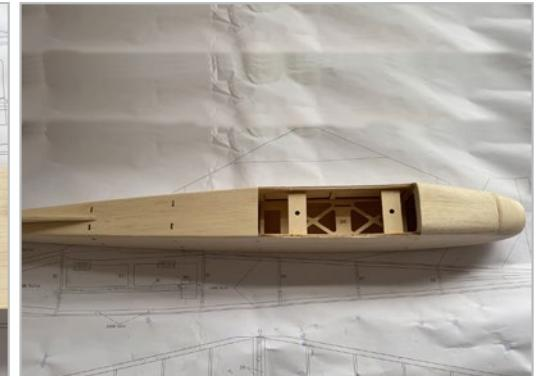
Jetzt kann der komplette Rumpf mit aufgesetztem Akkudeckel in Form geschliffen werden. Analog zur Verbrennerversion auch die Kanten an den Rumpfseitenwänden abrunden.
