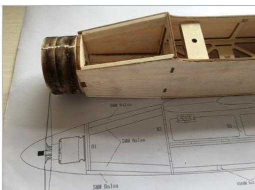
Der Rumpfkopf besteht am Übergang zum Spinner aus vorgerundeten Balsaformstücken (B21 5x). Diese sollten ausreichend Platz für den verwendeten Motor aufweisen. Geg. vor Verklebung nacharbeiten.
