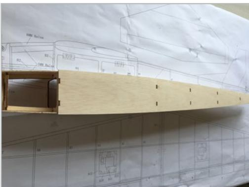
Kleben Sie die obere und untere Balsaabdeckung des Rumpfes ein. Achten Sie darauf, dass die Symmetrie auf beiden Seiten erhalten bleibt und sich der Rumpf nicht verzieht bzw. die Rumpfseitenwände zum Boden 90° aufweisen.
