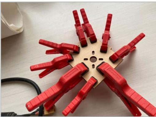
Sofern abweichend von unserer Empfehlung ein anderer Motor verwendet wird, prüfen Sie den Lochabstand des Motors mit dem Motorspan (B1 für Elektromotor) und passen diesen geg. an. Anschließend müssen beide Motorsparten sauber miteinander verklebt werden
