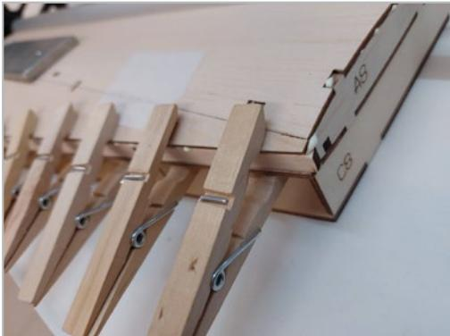
Anschließend kann die obere Balsabeplankung (A17) sorgfältig aufgeklebt werden. Wir empfehlen die obere Beplankung ausreichend zu beschweren und die Beplankung möglichst gut mit Stoßnadeln und Klemmern zu fixieren damit dies Beplankung gut verklebt ist und dem Profilverlauf korrekt folgt.
