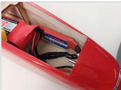
Verbinden Sie den Regler mit den Motoranschlüssen und überprüfen Sie die korrekte Drehrichtung. Anschließend wird der Regler im Rumpf z.B. mit Doppelklebeband o.ä. befestigt. Achten Sie dabei auf ausreichend „Luftraum“ um den Regler herum. Um Überhitzung zu vermeidenwickeln Sie diesen nicht in Schaumstoff o.ä. ein.
