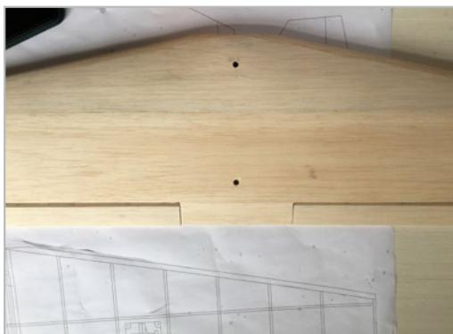
Zum Abschluss der Arbeiten an der Tragfläche müssen noch die Ruderscharniere gesetzt werden wie in der Abbildung ersichtlich. Achten Sie hierbei besonders auf mittiges Platzieren der Ruderscharniere damit später das Ruder sauber und ohne Stoßkante dem Profilverlauf der Tragfläche folgt.
