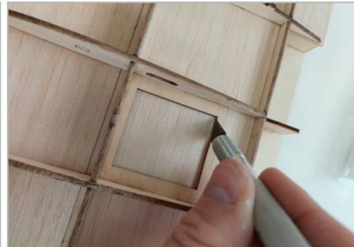
Jetzt müssen die beiden Servoaufnahmen (A13) zwischen den Rippen, an der im Plan eingezeichneten Position, eingeklebt werden. Zuvor verkleben Sie den Verstärkungsrahmen (A12) wie in Schritt # 30 ersichtlich und schneiden in die Beplankung eine Öffnung, exakt im Ausmaß des Rahmens.
