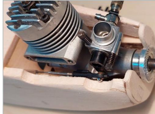
Vergaseranlenkung je nach Vergasertyp herstellen. Auf Grund der vielfältigen Möglichkeiten liegt dem Baukasten dieses Zubehör nicht bei. Das Servo sitzt vor dem Höhen-, und Seitenruderservo.
