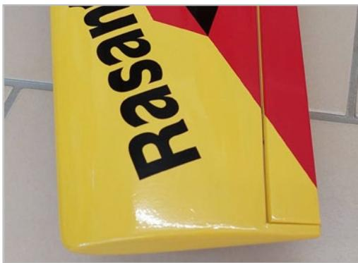
Die beiden Randbögen (A22) ankleben und im Profilverlauf, wenn das Ruder in Neutralstellung ist, verschleifen und abrunden. Hier im Bild am Beispiel des fertig bespannten Modells.
