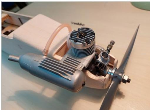
Montieren Sie den Schalldämpfer und verbinden Sie sämtliche Kraftstoffschläuche mit Motor und Schalldämpfer.
