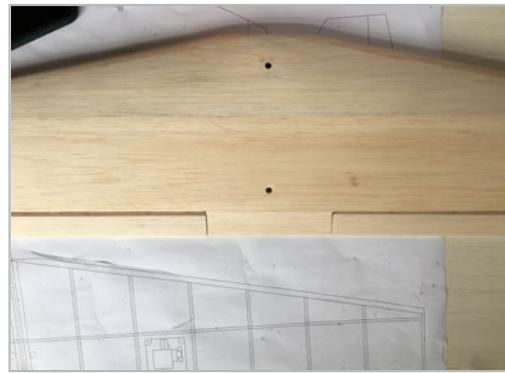
Weiters muss die Bohrung für die Tragflächenbefestigung von der Unterseite durchgebohrt werden.
