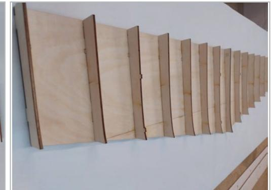
Die Rippentragfläche wird auf einer eigens dafür vorgesehenen Bauhelling aufgebaut, um verzugsfreien und symmetrischen Aufbau zu gewährleisten. Diese Bauhilfe (Bauhelling) aus 3mm Sperrholz, ist bereits fertig vorgefräst und muss nur noch verklebt werden, um nachfolgend den Bau der Tragflächen beginnen zu können. Beachten Sie, dass die beiden Sperrholz Bodenteile richtig positioniert sind. Als Hilfestellung sollten die beiden Laserlinien zueinander ohne Versatz fluchten.
