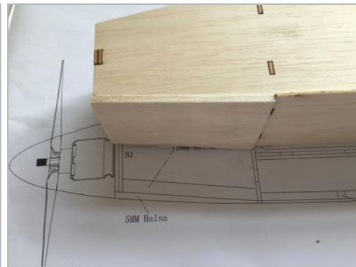
Anschließend müssen die oberen und unteren 5mm Balsaverstärkungen (B20), sowie der Rumpfboden-deckel (B17) eingeklebt werden wie in der Abbildung ersichtlich.
