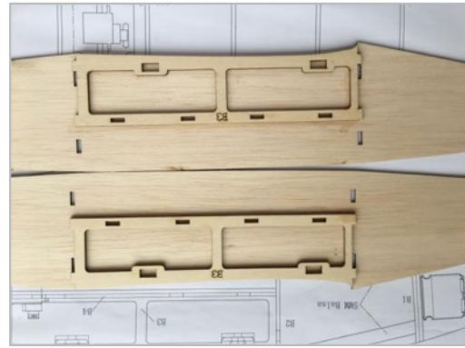
Nun müssen die beiden Rumpfseitenwände mit den Sperrholzverstärkungen (B3), wie in der Abbildung ersichtlich, verklebt werden.
