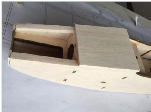
Anschließend kann der Rumpf im Bereich des Tanks mit 5mm Balsabrett (B18) verschlossen werden. Die obere Verstärkung (B20) wird wie unten eingeklebt.
