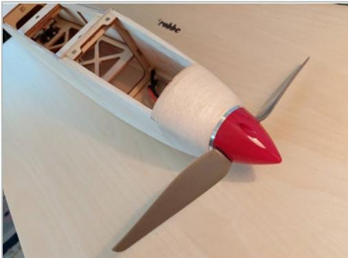
Mit der Montage des Spinners und der Luftschaube ist der Motor fertig montiert.
