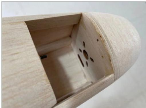
Anschließend die rumpfseitige Magnetaufnahme (B23) verkleben und die vordere Bohrung für den Stahl-draht im Motorspart übertragen und herstellen. Das Einkleben der Magnete beendet diesen Bauabschnitt. (Achtung Nord-Südpol beachten, um Abstoßung der Magnete zu verhindern!)
